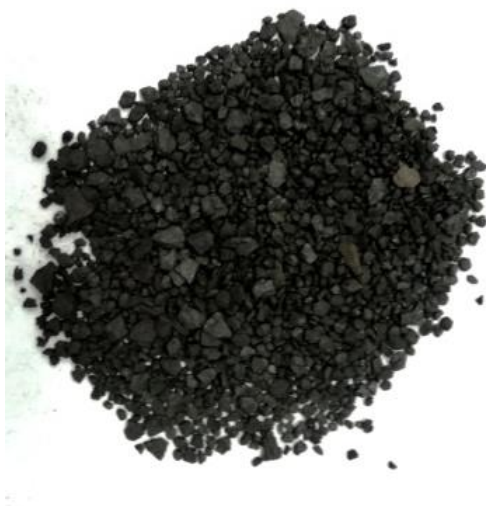
Сурет 2.9 - Кузнецк көмір кенішінен алынған көмір шикізатын механикалық жолмен өңдеу.
