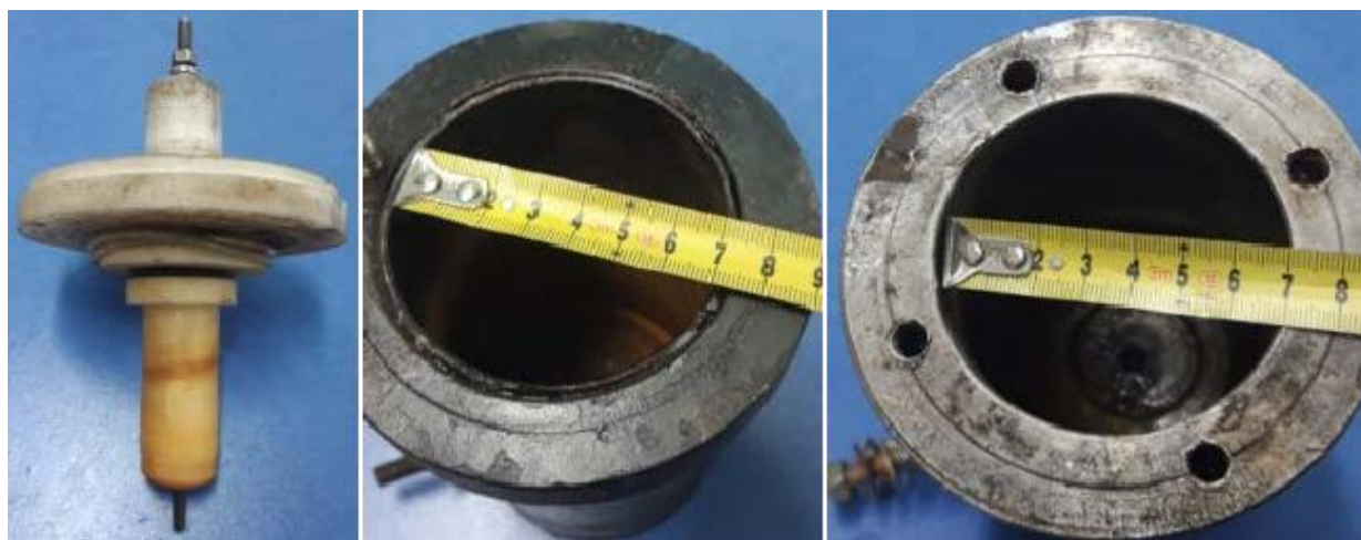
Сурет 2.13 - Ұнтақтау құрылғысының ішкі бейнесі мен олардың өлшемдері [109, Б.261]
